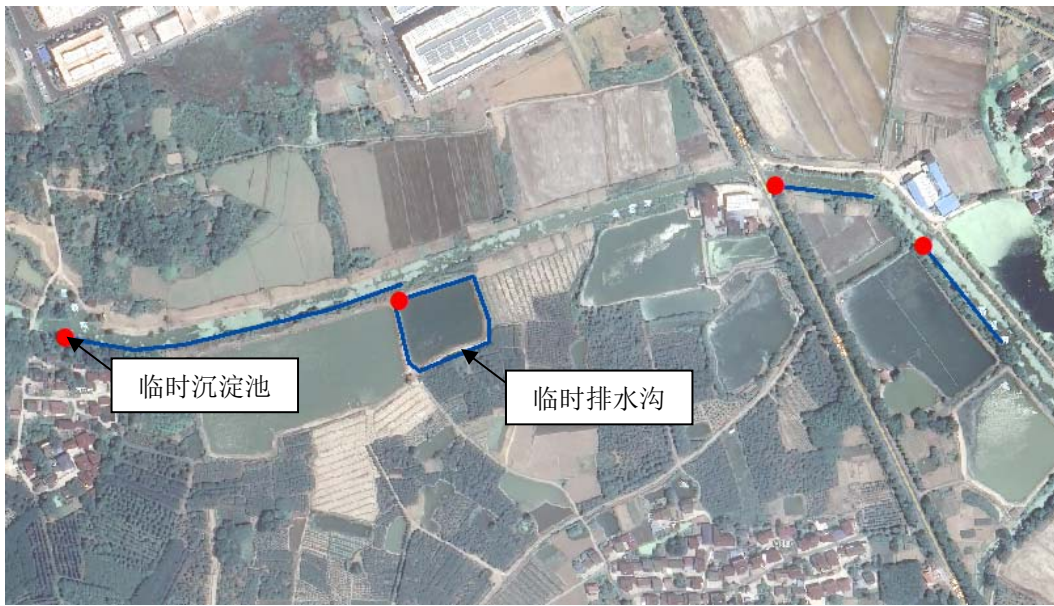
图 2-6 临时排水沟和沉淀池示意图
