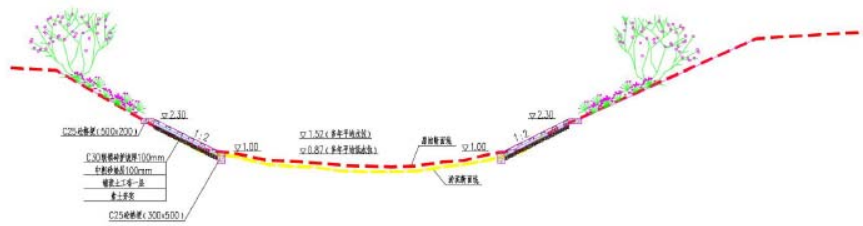
图 2-1 新建联锁块护坡标准断面图
