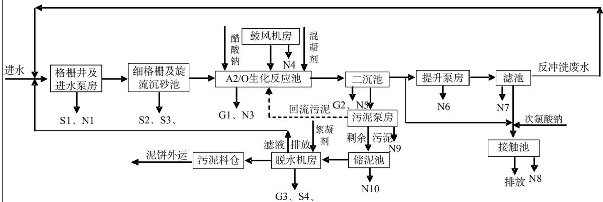
图 4-1 南渡污水处理厂处理工艺流程图
