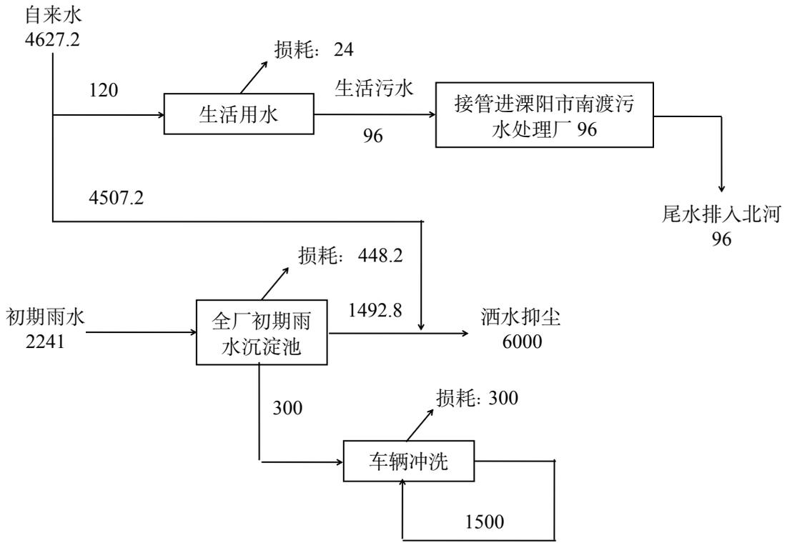
图 2-1 全厂水平衡图 单位: t/a
