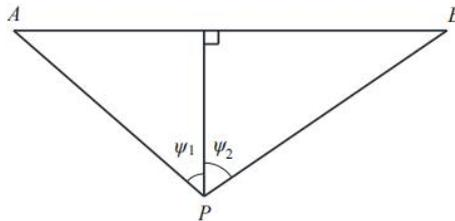
图 4-3 有限路段的修正函数，A~B 为路段，P 为预测点
