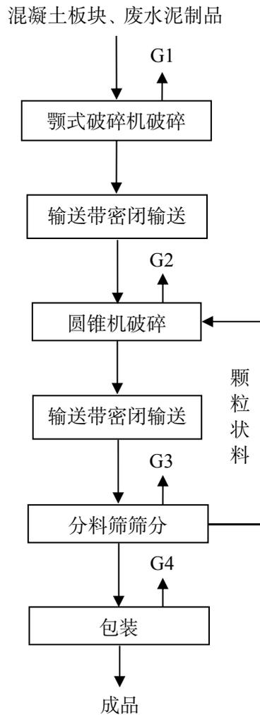
图 2-3 原有项目生产工艺流程图
