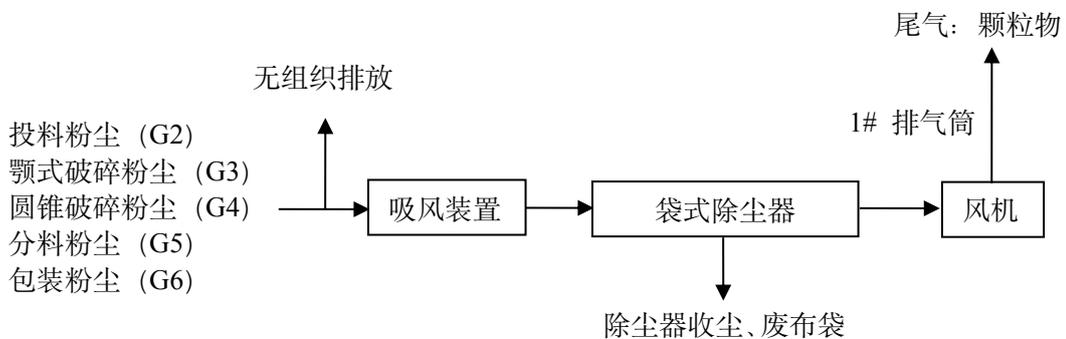
**图 4-2 生产工序废气处理装置示意图**
