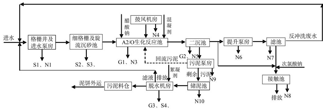
图 1-1 污水厂处理工艺流程图
