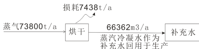
图 3.1.7-1 现有项目一期蒸汽平衡图
