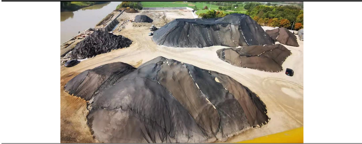
原料堆场采用防尘网覆盖
