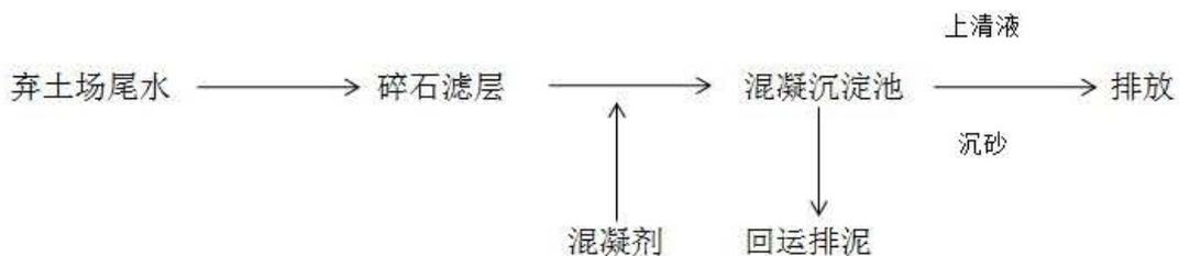
图 5.1-3 排泥场尾水处理流程图
