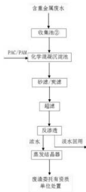
图 1-2 溧阳市南渡新材料园区污水处理有限公司重金属废水处理工艺流程图
