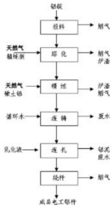
图 2-6 电工铝杆生产工艺流程及产污节点图
