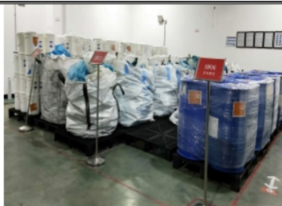
1#和2#危废库房内部图（防腐防渗、分区存放）
