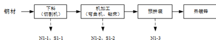
图 3.3.1.5-1 机加工生产工艺流程及产污环节图
