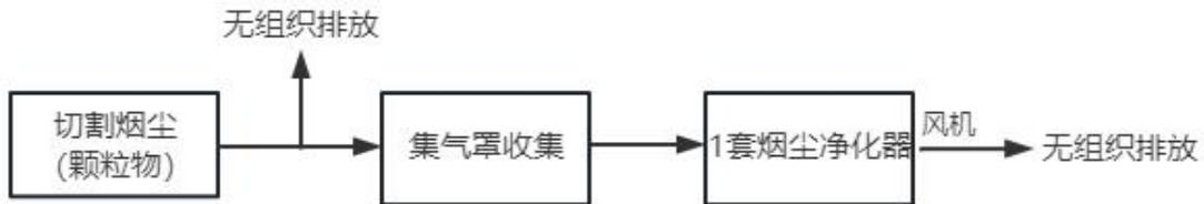
图 4-1 切割烟尘处理流程
