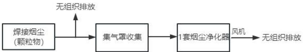
图 4-2 切割烟尘处理流程
