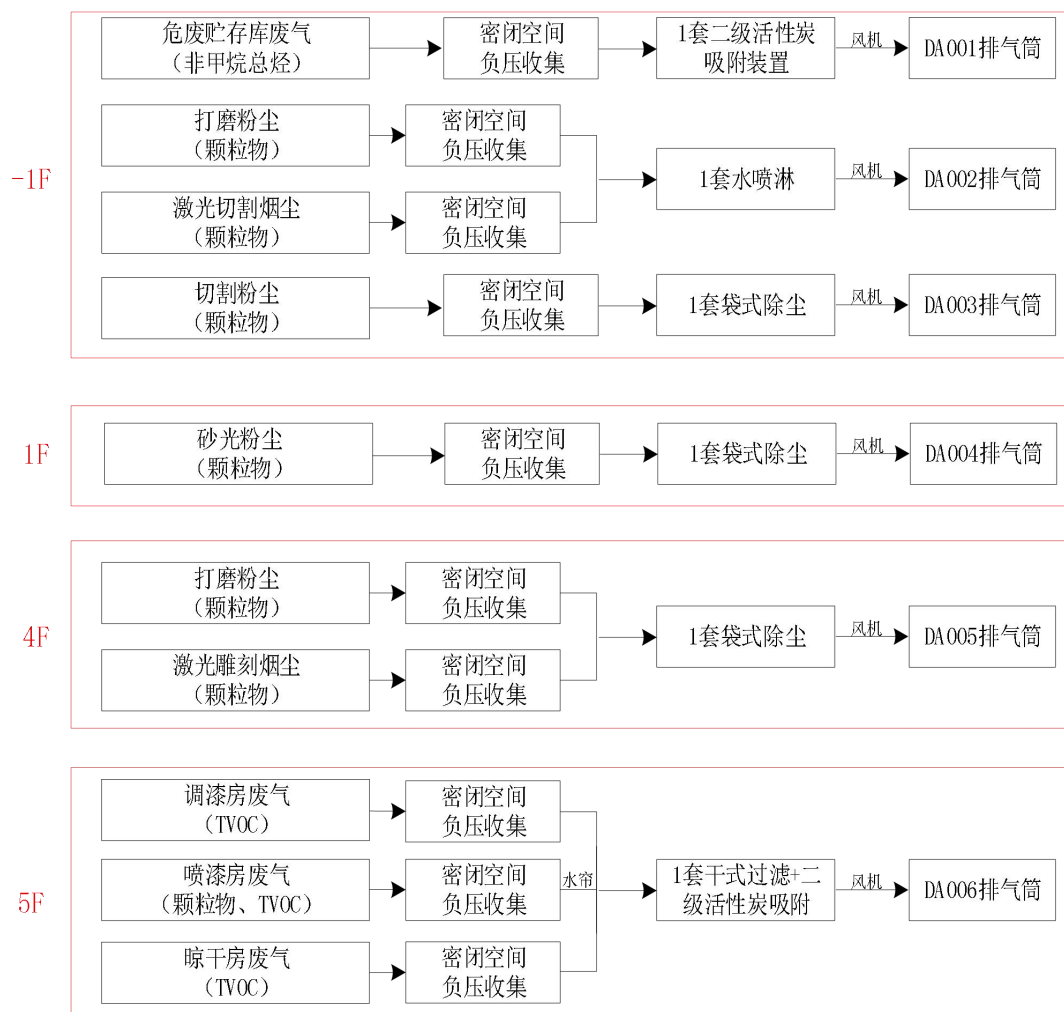
图 4-1 项目废气治理措施及工艺流程图
