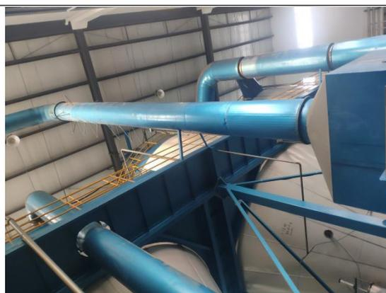
干燥脉冲布袋除尘-气料分离装置
