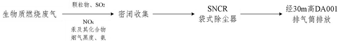
图 4-1 生物质燃烧废气处理流程图
