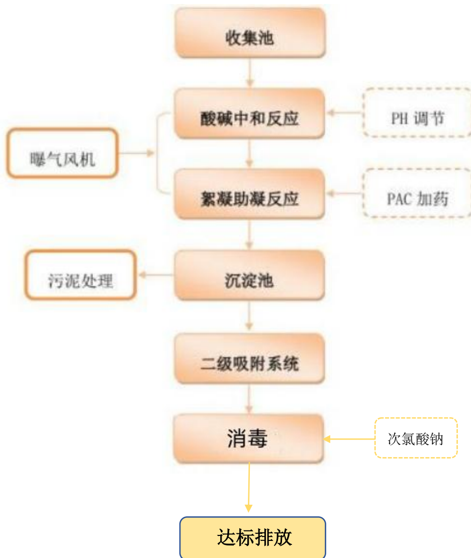
图 4-2 废水处理工艺图
