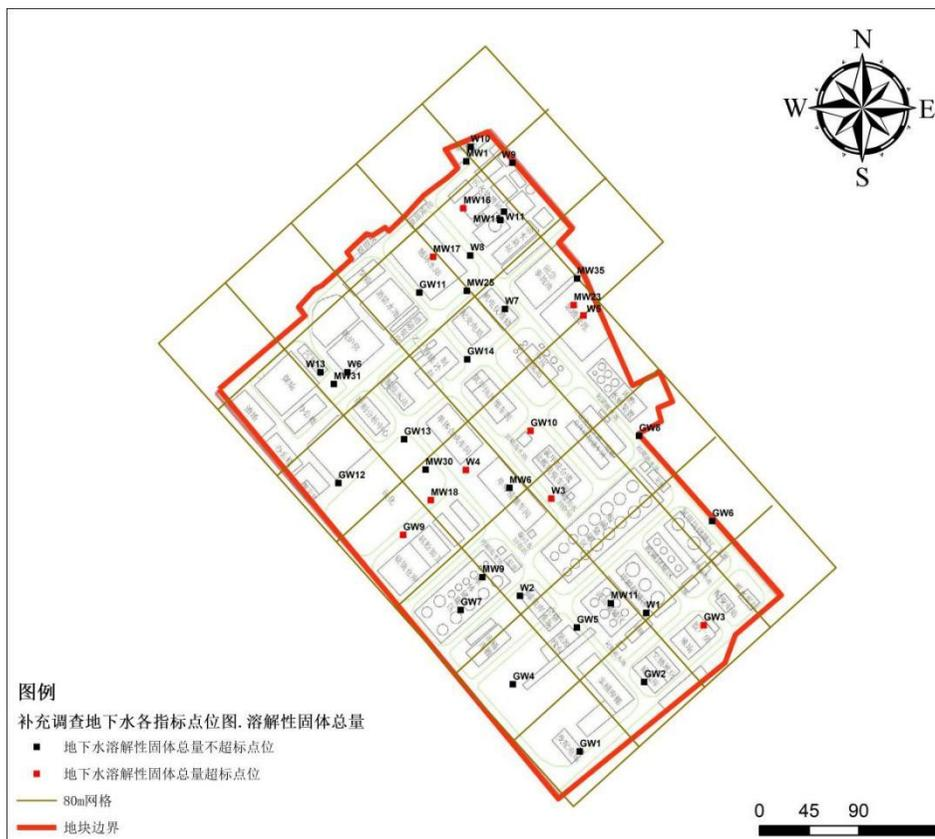
图 3.3-42 补充调查（第一次进场）地下水（溶解性固体总量）超标点位分布图
