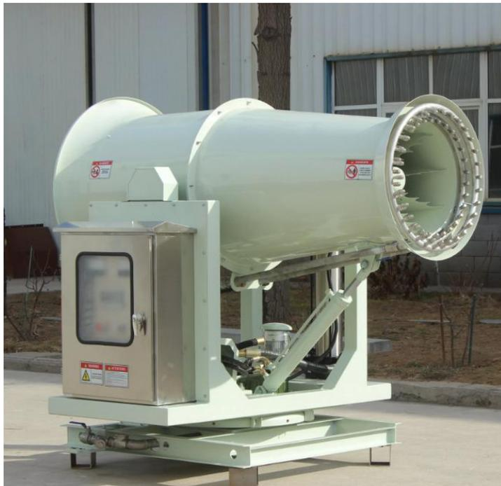
图 5.1-2 雾炮机示意图
