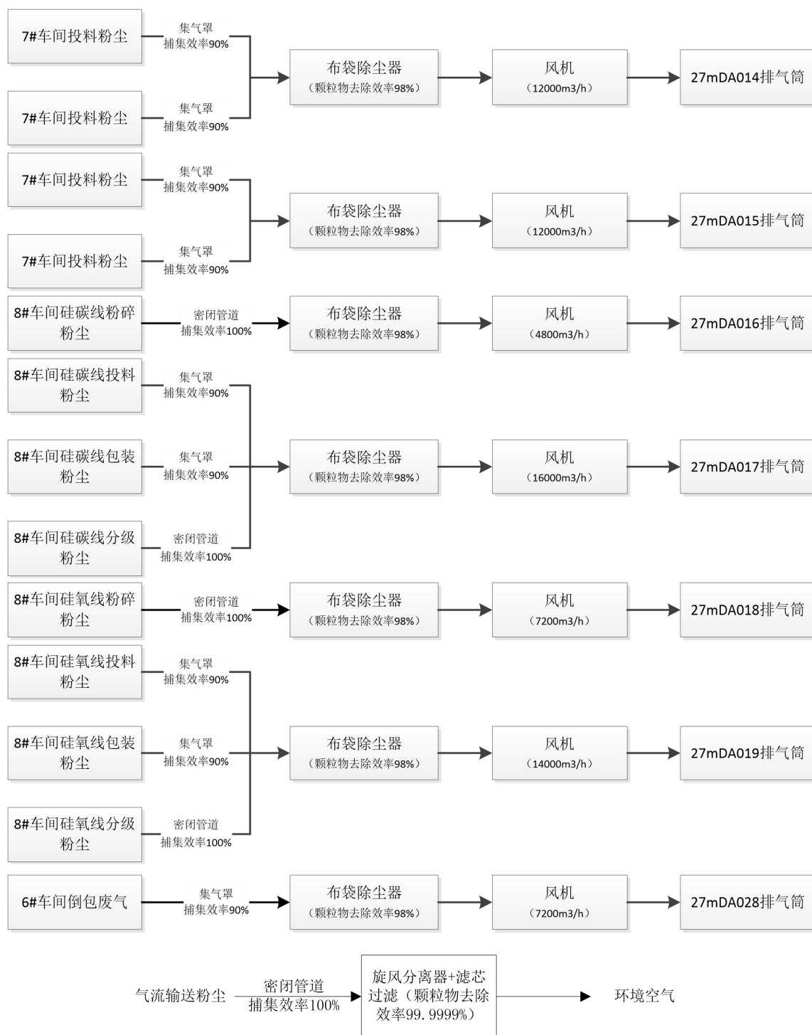
图 7.1.2-1 7#、8#车间含尘废气收集处理流向图
