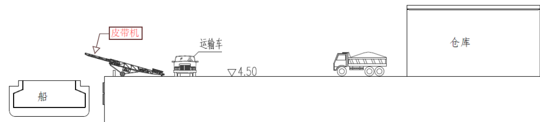
图 2-5 装船工艺断面示意图
