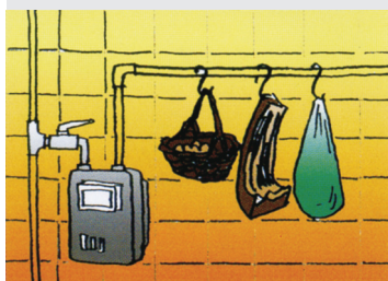
不可在煤气管道上拉绳悬挂物品
