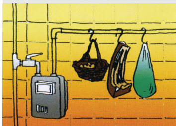
不可在煤气管道上拉绳悬挂物品
